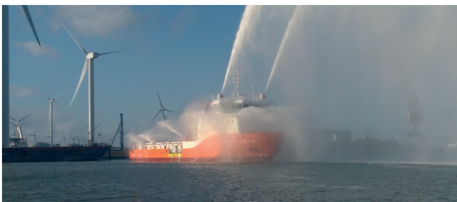
De ESNAAD 222 test haar FiFi installatie
