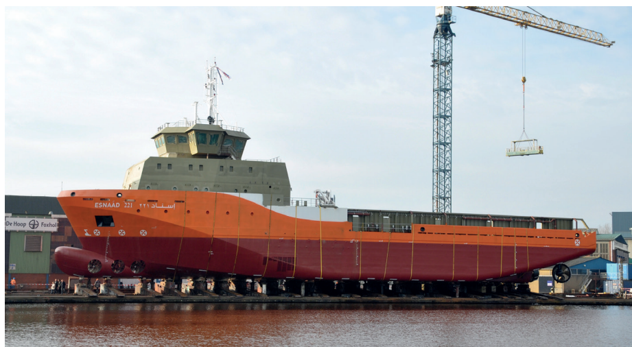
De ESNAAD 221, met boeg- en hekschroeven goed zichtbaar
