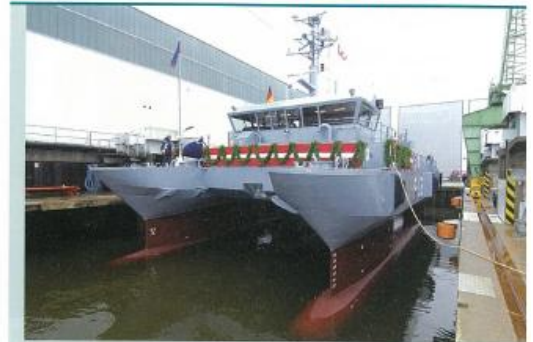
Da das Fendersystem der Lotsenboote übernommen wird, sind die neuen 25m SWATH@A&R Patrouillenboote für alle Arten von Boarding Einsätzen prädestiniert | Bild: Abeking & Rasmussen
