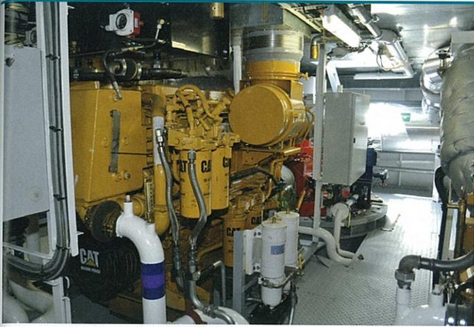
Jede der beiden Caterpillar-Antriebsmaschinen leistet 635 kW
